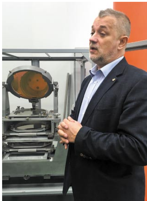
◀ Директор ИТМО НАН Беларуси Олег Пенязков демонстрирует интерферометрический стенд по контролю качества обработанных поверхностей
